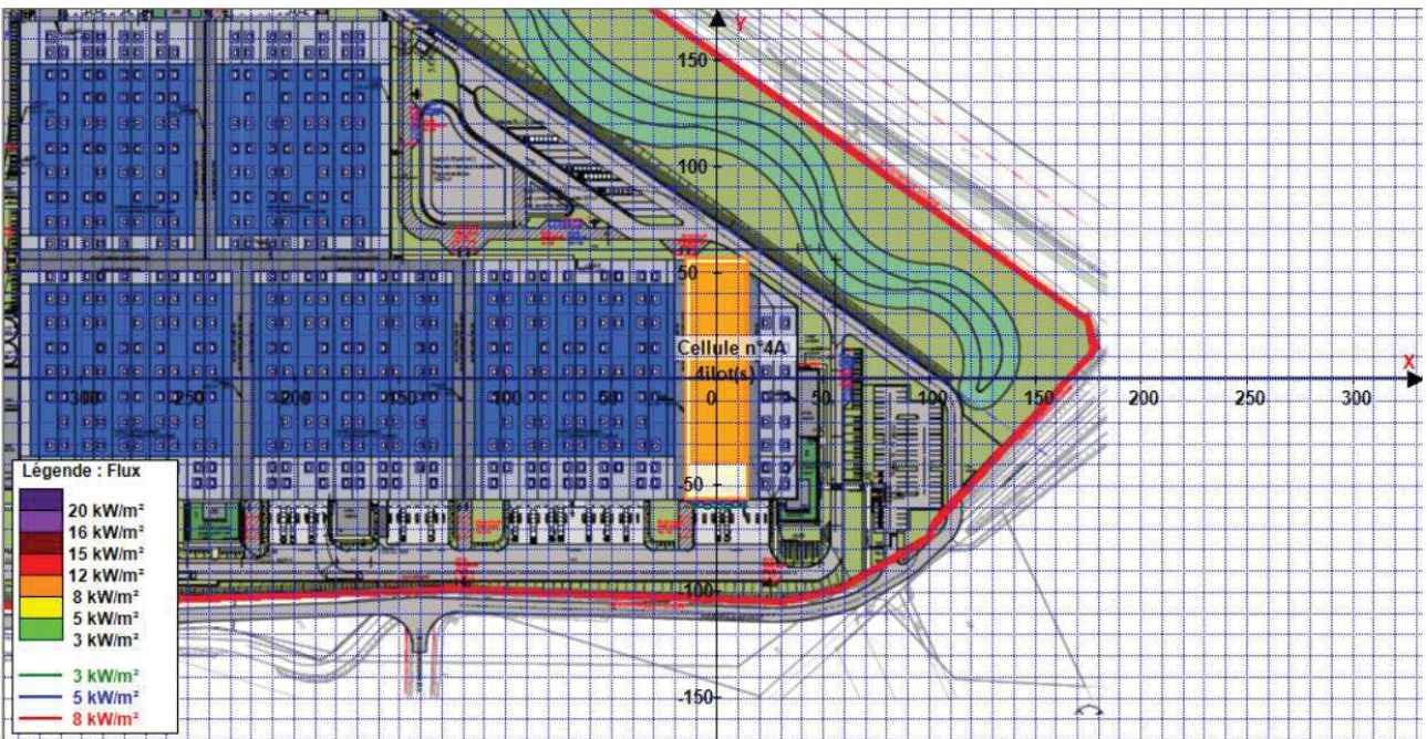
Figure 18 : Cartographie des flux thermiques – cellule 4A (Palette 2662 – masse)
