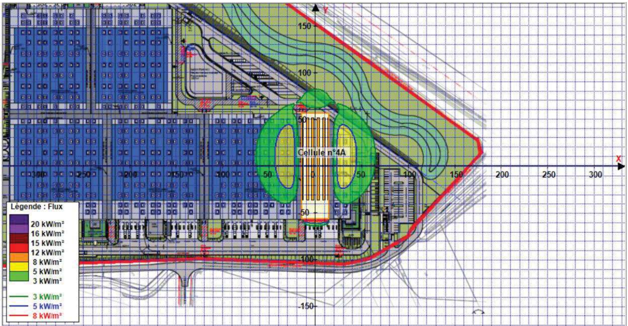
Figure 17 : Cartographie des flux thermiques – cellule 4A (Palette 2662 – rack)
