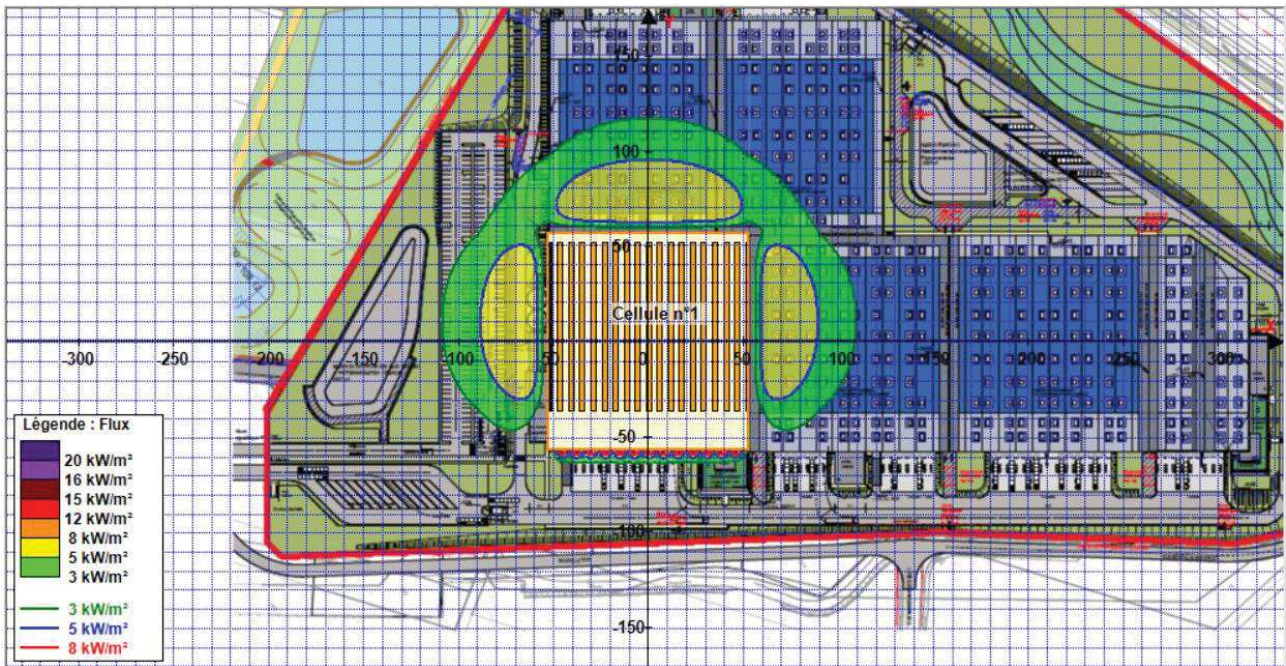
Figure 9 : Cartographie des flux thermiques – cellule 1 (Palette 2662 – rack)
