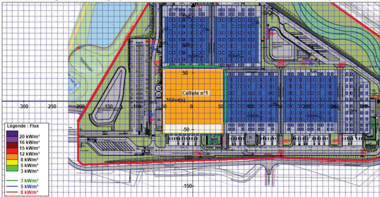
Figure 10 : Cartographie des flux thermiques – cellule 1 (Palette 2662 – masse)
