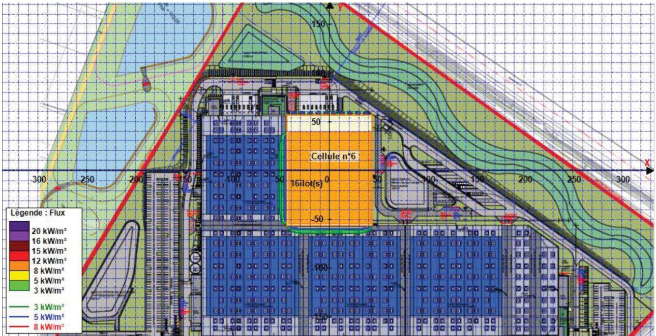
Figure 24 : Cartographie des flux thermiques – cellule 6 (Palette 2662 – masse)
