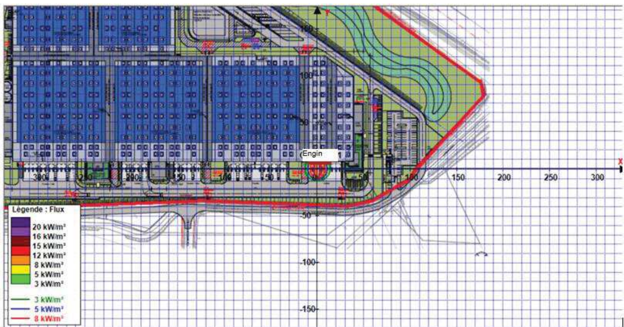
Figure 10 : Flux thermiques associés à l'incendie engin de transport
