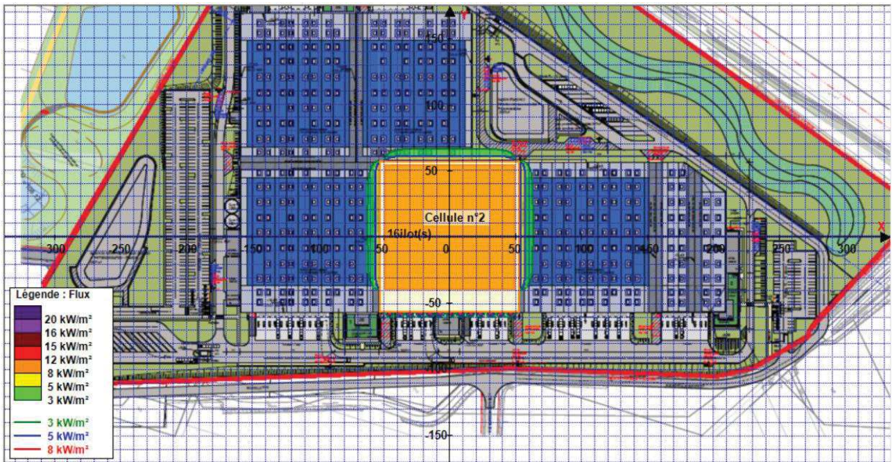
Figure 12 : Cartographie des flux thermiques – cellule 2 (Palette 2662 – masse)
