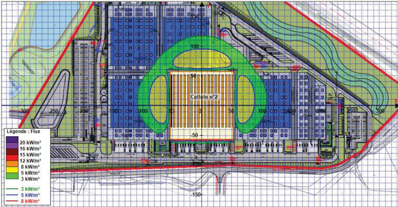
Figure 11 : Cartographie des flux thermiques – cellule 2 (Palette 2662 – rack)
