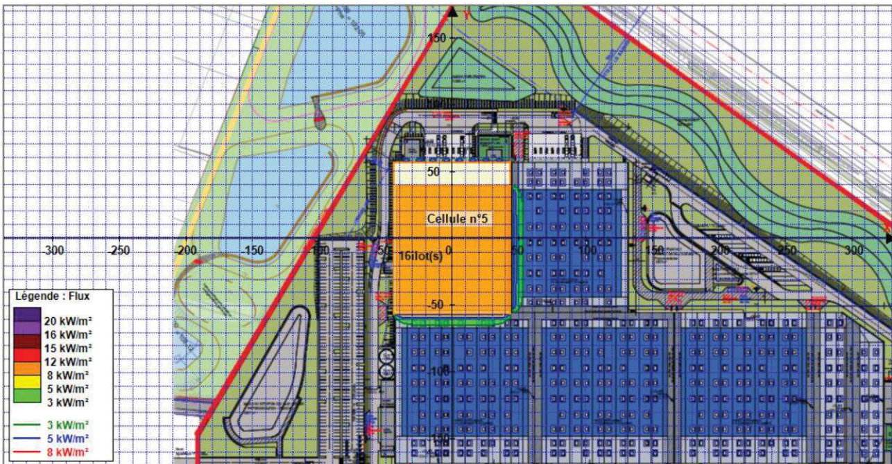
Figure 22 : Cartographie des flux thermiques – cellule 5 (Palette 2662 – masse)
