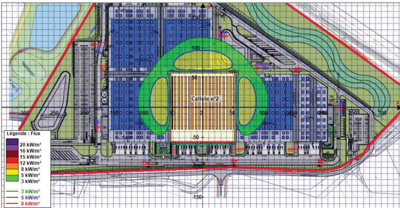
Figure 2 : Flux thermiques associés à l'incendie de la cellule 2
