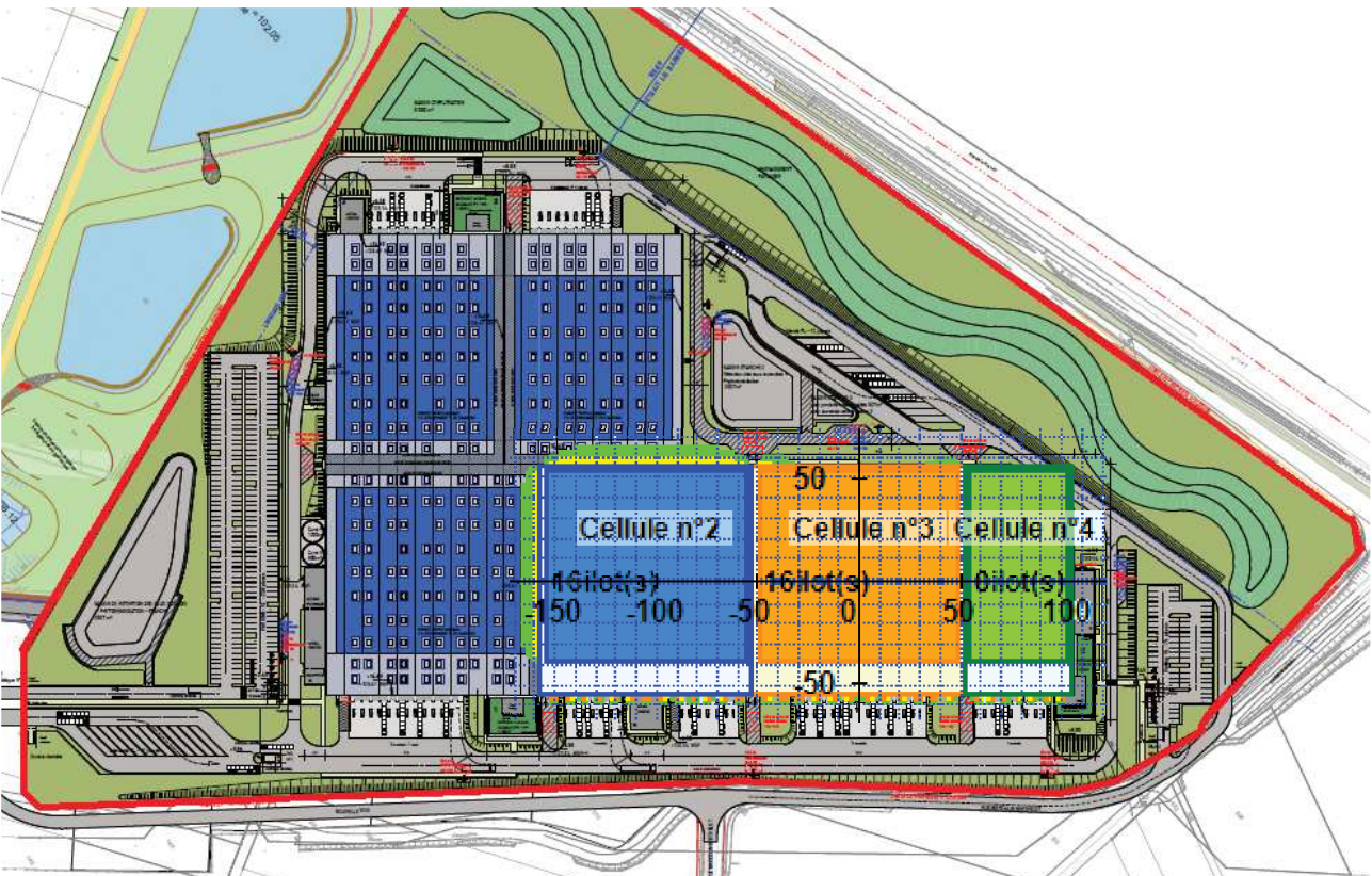
Figure 25 : Cartographie de l'incendie des cellules 1, 2 et 3
